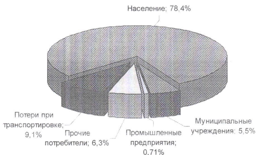
Структура распределения водопроводной воды
